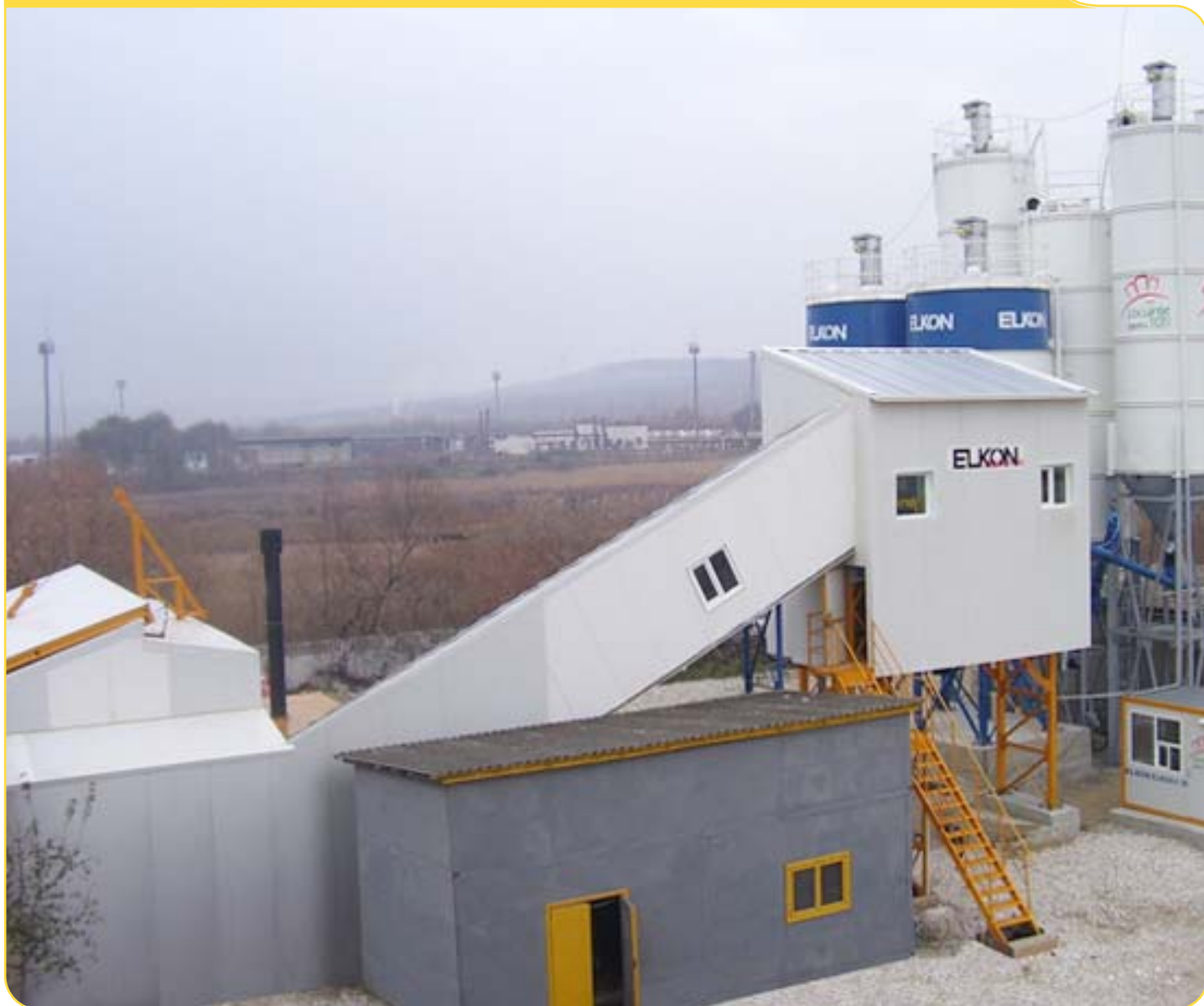
Общий вид бетонного завода ELKOMIX-35 всепогодного исполнения
